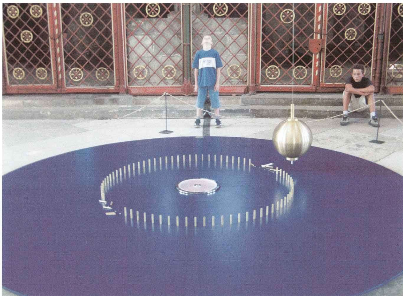
Installationsort Magdeburger Dom von Juli bis November 2002 – Umgestoßene Stifte zeigen die Drehung der Schwingungsebene an
