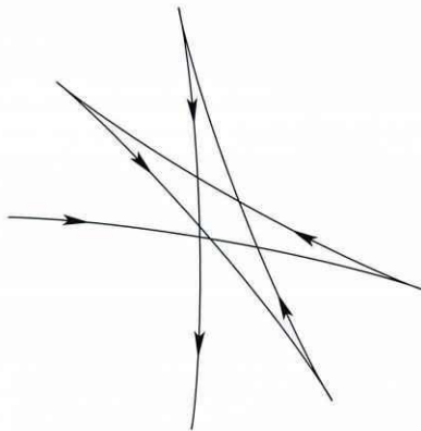
Rosettenförmige Bahn des Pendels auf dem Erdboden
