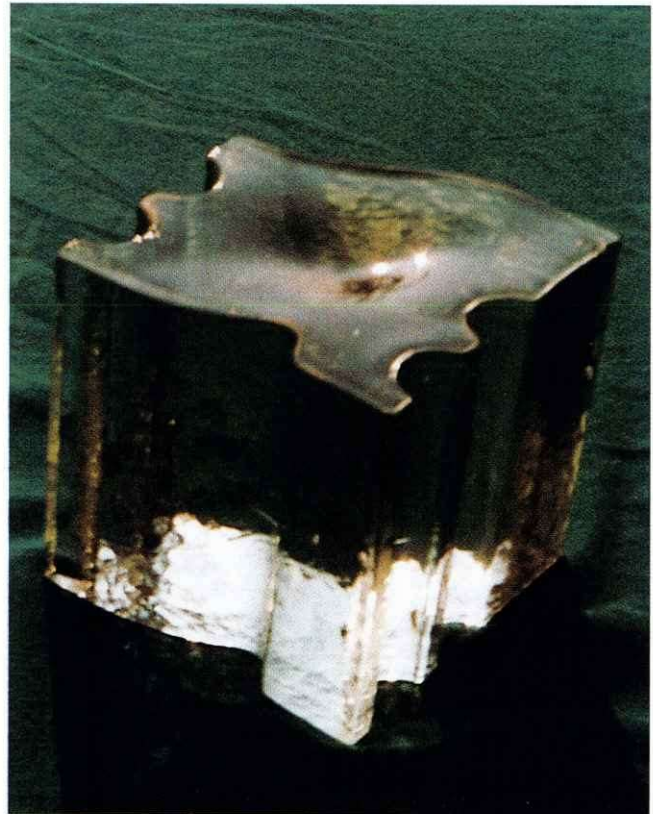
einzelner Würfel, 9,9 x 9,5 x 9,5 cm Die Gußglaswürfel ermöglichten unterschiedliche plastische Ebenen. Stabilisierung durch innenlaufende Edelstahlverspannung, Verfugen durch Kunstkautschuk
