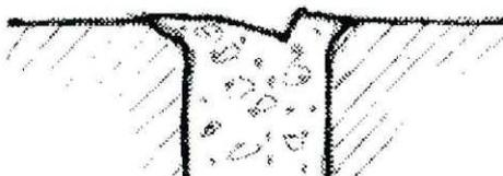
Der Befund im westlichen Bruchsteinverband des Widerlagers unterstützt letztere Annahme, da ein großer, bis 90 cm nach Süd reichender Bruchstein in den mit Kerbfugen abgezogenen Setzmörtel der Toranlage eingebunden war (Abb. 24).
