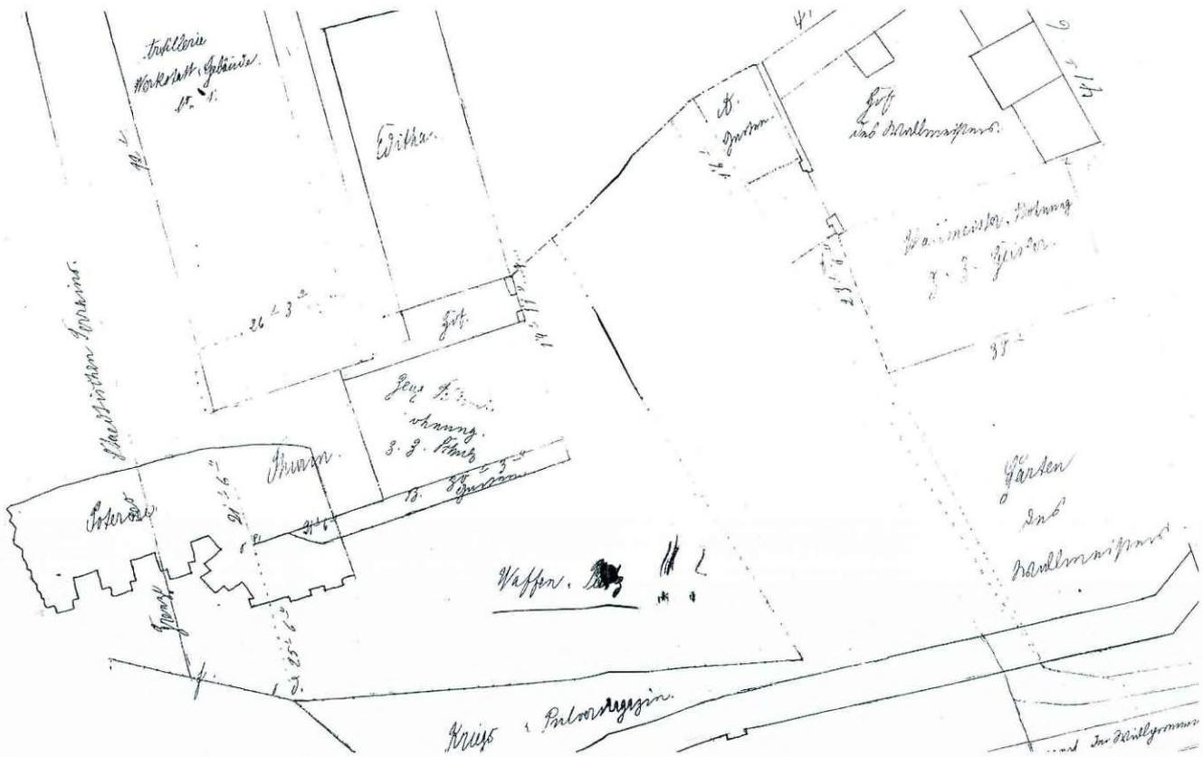
Abb. 19: Lagevermessung des als Kriegs - Pulvermagazin genutzten Gewölbeganges. Teilweise unter dem Turm an der Stirnseite der Artilleriewerkstätten ist eine abgewinkelte Poterne kartiert. StA Magdeburg. Rep. All P
