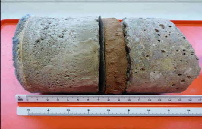
Bild 1: durchkernter Fußboden
