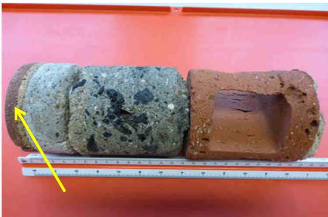
Bild 3: Durchkernter Fußboden
