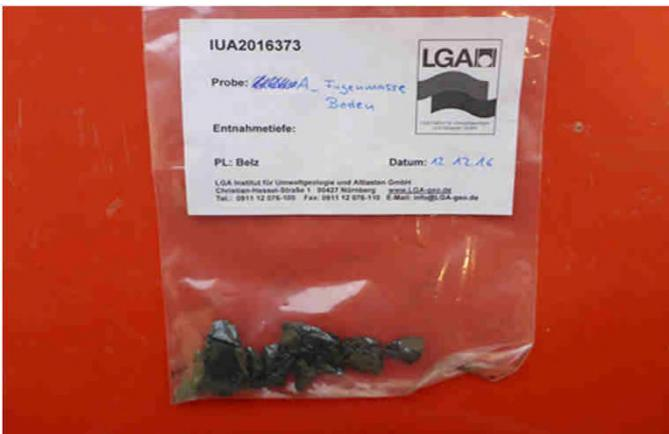
Bild 3: Entnommene Materialprobe A\_Fugenmasse-Boden
