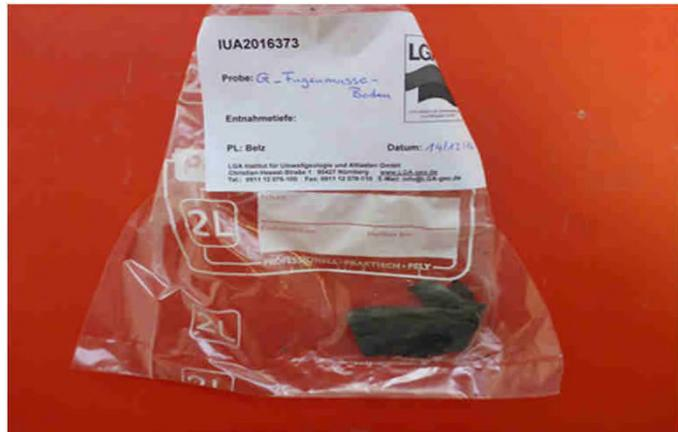
Bild 3: Entnommene Materialprobe der Fugenmasse
