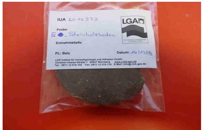
Bild 4: Untersuchter Steinholzboden (ca. 1,5 cm dick)
