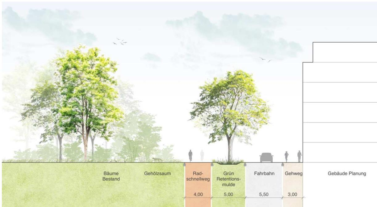
Querschnitt Vertikale 4
