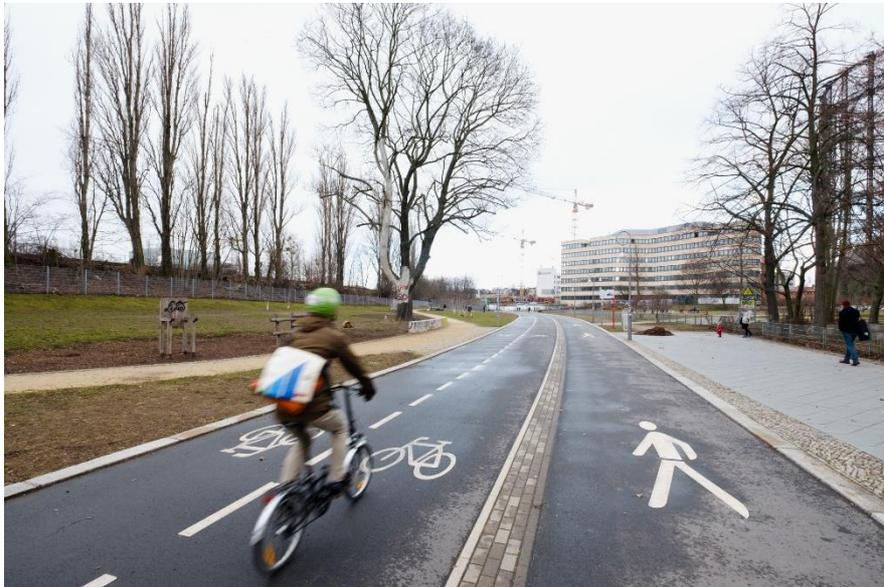
Abb. 8: Selbstständiger Geh-/Radweg im RSV-Standard in Berlin (Markierungen fehlen, da keine Radschnellverbindung) (eigenes Foto)
