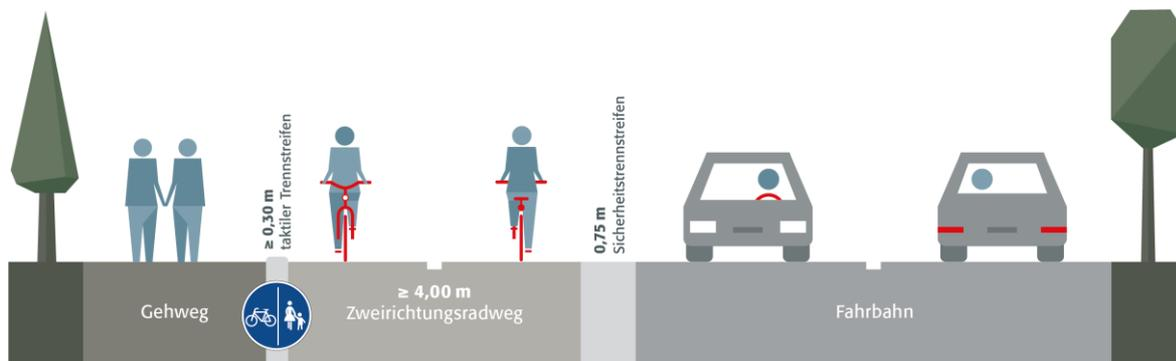
Abb. 10: Musterquerschnitt Zweirichtungsradweg innerorts (eigene Darstellung)
