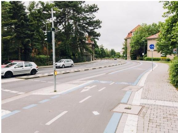
Abb. 5: Zweirichtungsrادweg auf der Radschnellverbindung in Göttingen mit Randmarkierung in Blau (nicht mehr anzuwenden) (eigenes Foto)
