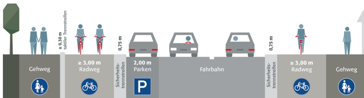
Abb. 9: Musterquerschnitt getrennte Geh-/Radwege (eigene Darstellung)
