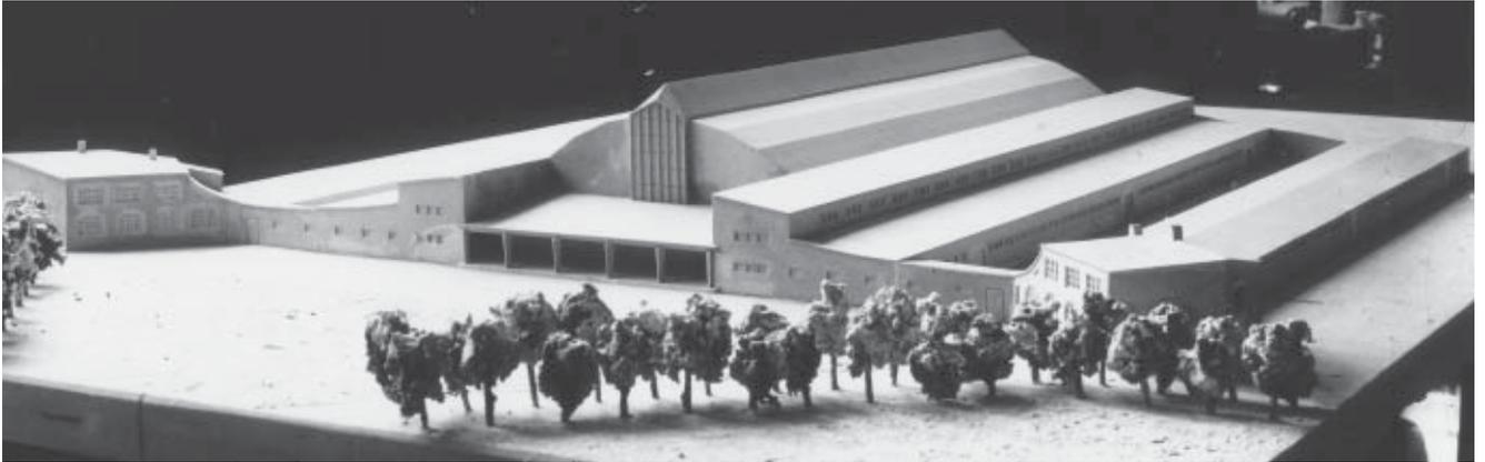
Das Modell zeigt den Blick von Nordwest auf die Ausstellungshalle. Entgegen der späteren Ausführung sind die Kopfbauten mit lediglich leicht ansteigenden Flachdächern versehen. Der leichte, abfallende Schwung in der Verbindung zu den Stallbauten wurde im Bau zugunsten einer geraden Linie aufgegeben.
