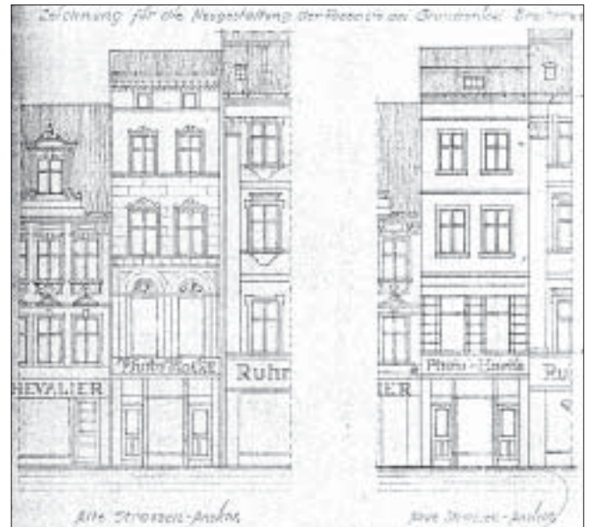
Fassadenzeichnung des Hauses Breiter Weg 27 vor und nach den Umbauten 1933/34
